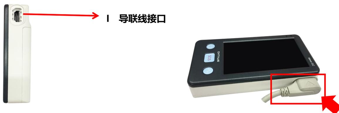
图 3-2 导联插入图示
